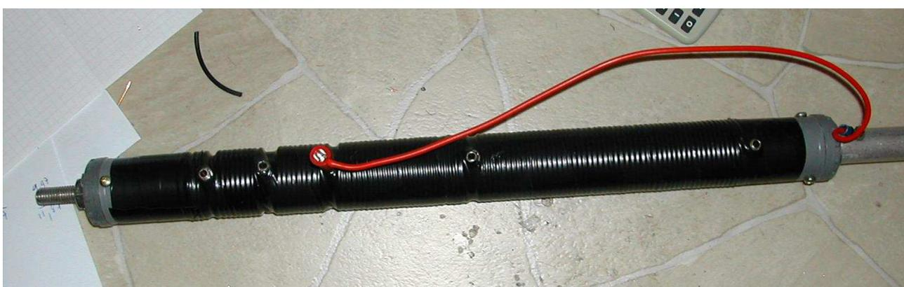
L'antenne finie et le blocage des spires par gaine thermo ou scotch noir. On voit les embouts bouchons pvc fixés par 3 vis parker.
